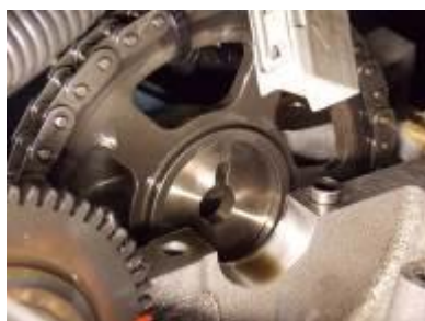
Camshaft sprocket groove damaged
